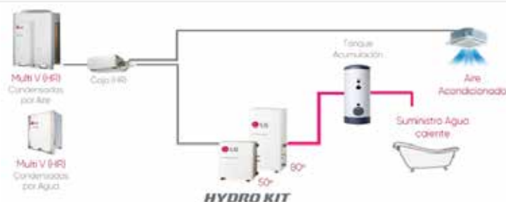
Sistema de Media Temperatura (50°C)
